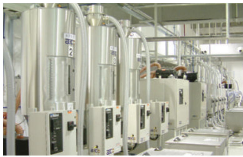
Централизованные системы сушки заменяют оборудование основного производственного цеха и сокращают общее энергопотребление.
