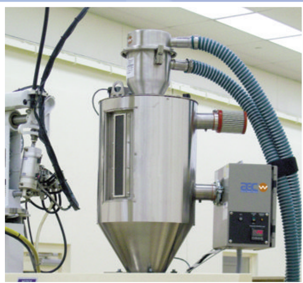
Компактные сушилки сжатого воздуха достигают низкую точку росы для сушки материала.
