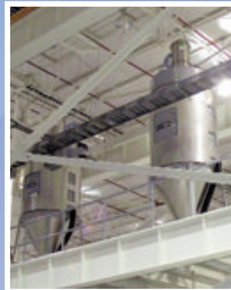
Высокотемпературные сушилки установлены непосредственно на загрузочном бункере оборудования
